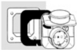
ДЛЯ ВСТРАИВАЕМОЙ ВЕРСИИ РЕЗИНОВАЯ ПРОКЛАДКА СО СТЕПЕНЬЮ ЗАЩИТЫ IP44 ГЕРМЕТИЧНО ВСТАВЛЯЕТСЯ МЕЖДУ БЕЗОПАСНОЙ РОЗЕТКОЙ 2P+T SCHUKO И СТЕНОЙ.
